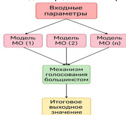
Рис. 3. Структура ансамблевой модели машинного обучения с механизмом голосования большинством
